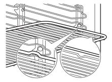
Небольшой выступ наверху повышает безопасность. Выступы также служат защитой от опрокидывания. Высокий ободок по периметру решетки служит для предотвращения соскальзывания посуды с решетки.
