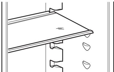
На стенках холодильника установлен ряд направляющих, позволяющих по желанию размещать полки из безосколочного стекла.
